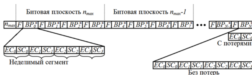
Рис. 3. Структура выходного потока в алгоритме НВСТ
