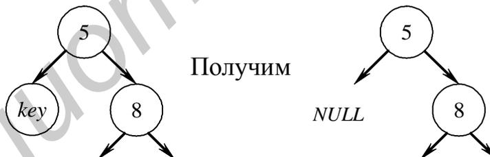
2. Удаляемый узел имеет только одного потомка, т. е. из удаляемого узла выходит ровно одна ветвь. Пример схемы удаления узла *key*, имеющего одного сына:
