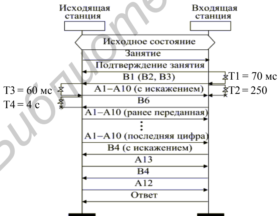
Рис. 3. Обмен многочастотными сигналами кодом «2 из 6» методом «Импульсный челнок» (прием сигналов с искажением)
