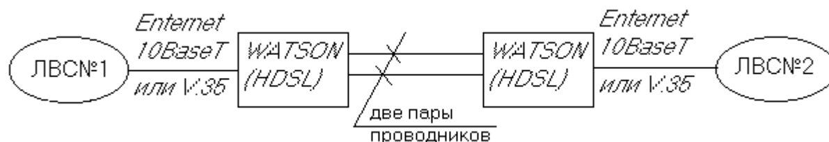
Рис.3.14. Способ объединения двух ЛВС в единую ЛВС
