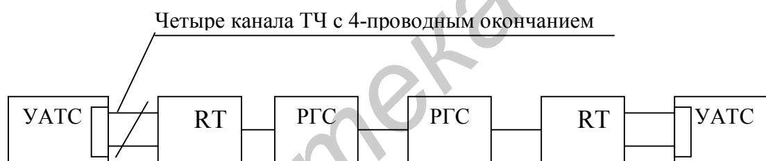
Рис.3.7. Способ соединения УАТС с использованием цифровой аппаратуры уплотнения TOPGAIN-4
