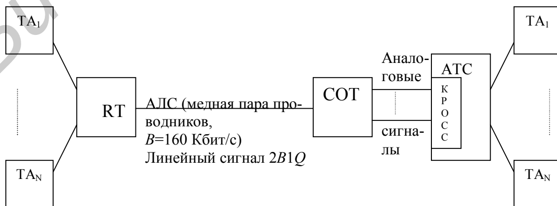
Рис. 3.6. Способ «прямого» включения абонентов с использованием TOPGAIN-4 ( RT – абонентский полуккомплект, COT – станционный полуккомплект)
