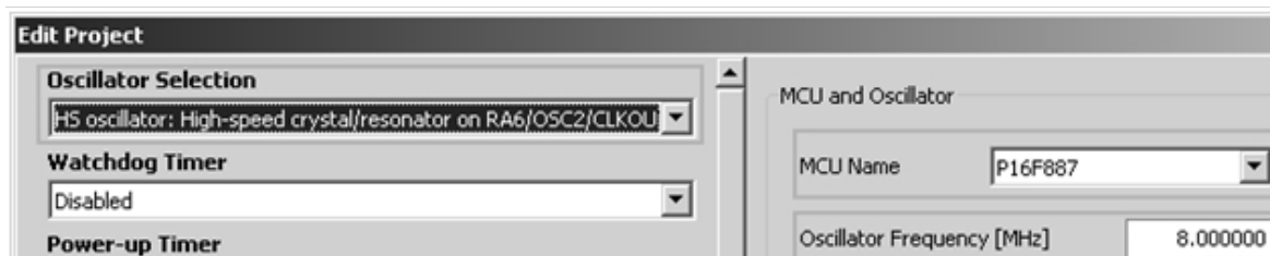
Рис. 1.43. Настройка конфигурационных битов микроконтроллера PIC P16F887
