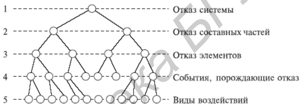
Рис. 1. Условная схема построения дерева отказов
